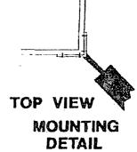
STEEL TUBES WELDED
