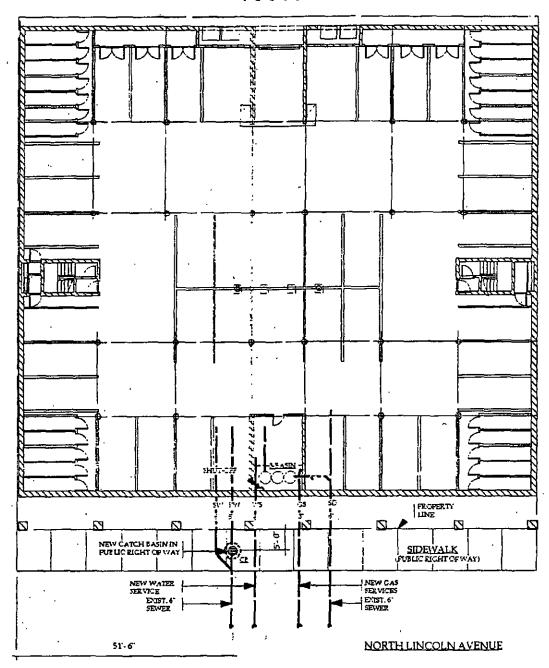
(A) LOIVER LEVEL PLUMBING, MECHANICAL & FLECTRICAL PLAN
